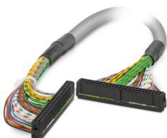
Câble rond pré-équipé; raccordement 1 : IDC/FLK connecteur femelle (1x 50-pôles); raccordement 2 : IDC/FLK connecteur femelle (1x 50-pôles); longueur de câble: 2,5 m
