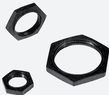
Écrous en plastique avec bague de centrage pour le montage sans vibration de capteurs cylindriques
