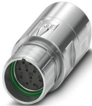
M23, Connecteur prolongateur, série: M23 PRO, droit, blindé: oui, Pour verrouillages rapides standard et ONECLICK, Nombre de pôles: 12, Sens de rotation: standard, type de contact: Connecteur femelle, Raccordement soudé, plage de diamètre de câble: 9 mm ... 15 mm, détrompage: N, L'article est sans plomb, conformément à la directive RoHS II, sans exception 6c (Pb < 0,1 %)
