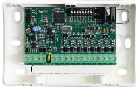
Extension pour centrales série VEDO, 8 entrées à configurer librement comme NF, NO, simple, double, triple équilibrage et double, ou sorties "open-collector" (100 mA max). Montage dans un boîtier plastique ininflammable, blanc RAL9003 avec contact anti-arrachement et blocage de l'ouverture du boîtier. Peut également être installée dans les boîtiers art. BOXPLASTIC, BOXMETAL et BOXFLUSH. Dimensions (L x H x P) 126 x 80 x 32 mm. EN50131 Grade 2.
