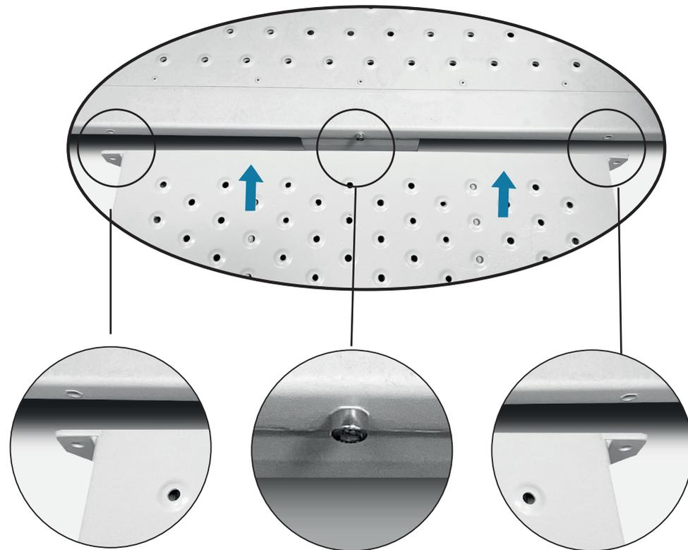
**9.2** Insérez la tête de la vis du milieu dans le trou prévu à cet effet, au milieu de l'extrémité haute de la rampe.
