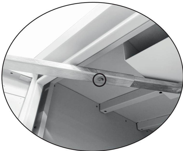
**2.1** Un mécanisme de sécurité s'enclenche automatiquement lors de l'ouverture complète de la porte, empêchant sa fermeture. Pour le débloquer, appuyez sur le bouton poussoir situé au milieu du bras métallique.
