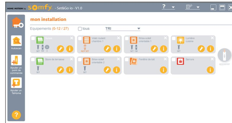
3 L'ensemble des moteurs et récepteurs de votre installation apparaissent à l'écran.
