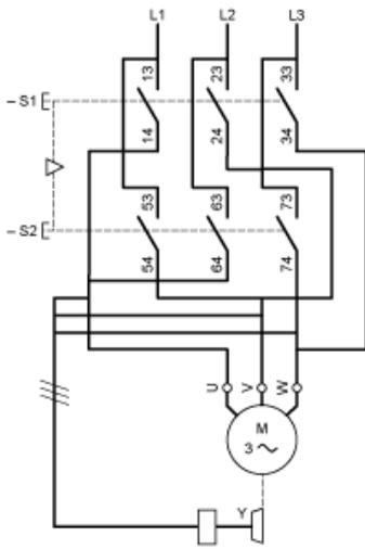
Contrôle de la commutation triphasée du moteur 1 vitesse 2 sens de marche, inversion du sens par 2 phases
