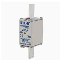
**Cartouche fusible, Basse tension, 200 A, AC 400 V, 120 kA, NH1, gL/gG, IEC, à double indicateur de fusion, pattes d'extraction conductrices**
