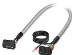
Câble rond blindé préconfectionné; raccordement 1 : IDC/FLK connecteur femelle (1x 14-pôles); raccordement 2 : IDC/FLK connecteur femelle (1x 14-pôles) (La tresse de blindage sort d'une extrémité de câble distincte.); longueur de câble: 3 m
