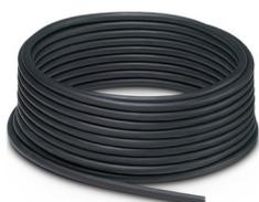
Câble principal pour répartiteurs pour capteurs/actionneurs, avec conducteur PE, non blindé, matériel PUR/PP, 19 pôles, 16 x 0,50 mm<sup>2</sup> et 3 x 1,00 mm<sup>2</sup>, longueur : 50 m
