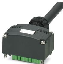
Capot de raccordement, application : Répartiteur pour capteurs/actionneurs, type de raccordement: Connecteur femelle M12 SPEEDCONNEC Plastique, nombre de prises: 8, affectation des prises: double, affichage d'état: Non; racc. câble multicond.: Raccordement vissé enfichable 180°, PUR/PVC, longueur du câble: 25 m, blindage: non
