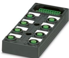
Répartiteur pour capteurs/actionneurs, embase, application : Standard, type de raccordement: Connecteur femelle M12 SPEEDCONNec Plastique, nombre de prises: 8, nombre de pôles: 5, détrompage: A, affectation des prises: double, affichage d'état: Oui, pnp; racc. câble multicond.: Raccordement vissé enfichable, blindage: non
