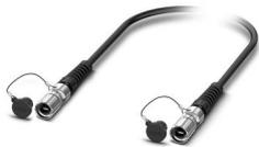
Série M17 MPO avec assemblage de connecteurs à fibre optique préconfectionné : connecteur mâle-connecteur mâle 24 pôles, fibre de verre multimode G62.5/125 µm OM1 avec raccordement vissé, longueur du câble fibre optique : 50 m, indice de protection IP67 après insertion, installation fixe dans des goulottes, des goulottes souterraines et des tubes de protection de câbles pour une utilisation en intérieur et en extérieur
