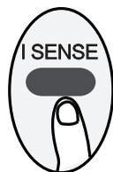
Lorsque la fonction I SENSE est activée, l'affichage à distance est la température réelle à son emplacement. La télécommande enverra ce signal au climatiseur toutes les 3 minutes d'intervalle jusqu'à ce que vous appuyiez à nouveau sur le bouton I SENSE.
