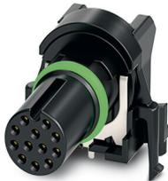
Porta-contatos, 12-pôles, connecteur femelle, coudé, M12, détrompage: A, Montage circuits imprimés, Soudage à la vague, Produit de remplacement selon RoHS II sans exception 6c (Pb < 0,1 %) référence : 1239456
