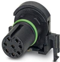
Porta-contatos, 8-pôles, connecteur femelle, coudé, M12-SPEEDCONNEC, détrompage: A, Montage circuits imprimés, Soudage à la vague, Produit de remplacement selon RoHS II sans exception 6c (Pb < 0,1 %) référence : 1239640
