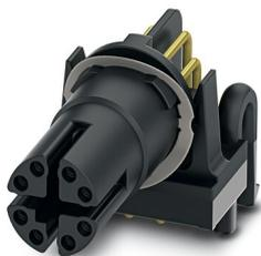
Porta-contatos, Ethernet CAT6<sub>A</sub> (10 Gbit/s), 8-pôles, connecteur femelle, coudé, M12, détrompage: X, Montage circuits imprimés, Soudage à la vague, Produit de remplacement selon RoHS II sans exception 6c (Pb < 0,1 %) référence : 1237389
