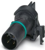
Porta-contatos, 4-pôles, Connecteur mâle, coudé, M12-SPEEDCONNEC, détrompage: A, Montage circuits imprimés, Soudage à la vague, Produit de remplacement selon RoHS II sans exception 6c (Pb < 0,1 %) référence : 1239628
