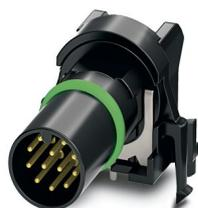
Porta-contatos, 12-pôles, Connecteur mâle, coudé, M12, détrompage: A, Montage circuits imprimés, Soudage à la vague, Produit de remplacement selon RoHS II sans exception 6c (Pb < 0,1 %) référence : 1239455
