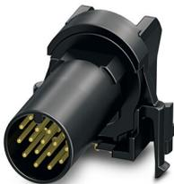
Porta-contatos, 17-pôles, Connecteur mâle, coudé, M12, détrompage: A, Montage circuits imprimés, Soudage à la vague, Produit de remplacement selon RoHS II sans exception 6c (Pb < 0,1 %) référence : 1239453
