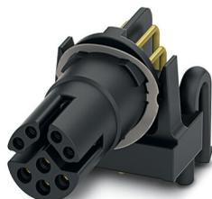
Porta-contatos CAT5 (CEI 11801:2002), 8-pôles, connecteur femelle, coudé, M12, détrompage: Y, Montage circuits imprimés, Soudage à la vague, Produit de remplacement selon RoHS II sans exception 6c (Pb < 0,1 %) référence : 1239450
