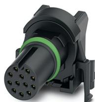
Porta-contatos, 12-pôles, connecteur femelle, coudé, M12, détrompage: A, Montage circuits imprimés, Soudage à la vague, Produit de remplacement selon RoHS II sans exception 6c (Pb < 0,1 %) référence : 1239452
