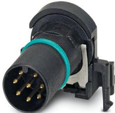
Porta-contatos, 8-pôles, Connecteur mâle, coudé, M12-SPEEDCONNEC, détrompage: A, Montage circuits imprimés, Soudage à la vague, Produit de remplacement selon RoHS II sans exception 6c (Pb < 0,1 %) référence : 1239644
