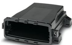
Boîtier non ventilé de la famille ECS, verrouillage à vis. Indice de protection IP66/67/69 en cas de combinaison avec la plaque frontale correspondante. Couleur : noire (9005), largeur : 164 mm, hauteur : 176 mm, profondeur : 64 mm
