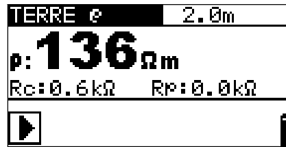
Figure 5.10: mesure de résistivité - résultats
