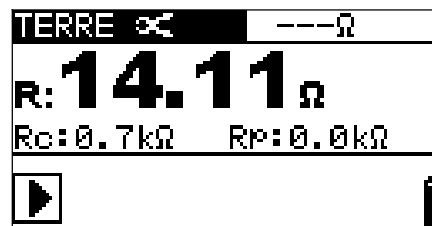
Figure 5.6 : mesure de résistance de terre sélective – résultats
