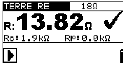
Figure 5.4 : résistance de terre RE – résultats
