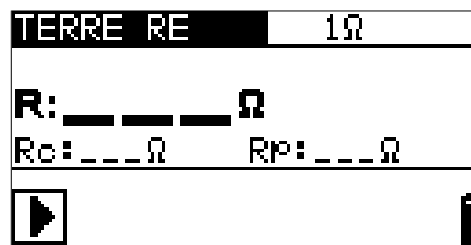
Figure 5.1 : résistance de terre RE – menu
