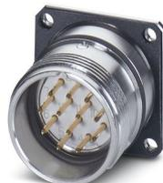
M23, Connecteur d'appareil face arrière, série: RC, droit, Verrouillage à vis, Joint plat, 4x Ø2,7, Epaisseur de paroi min.: 2,7 mm, Epaisseur de paroi max.: 3,5 mm, L'article est sans plomb, conformément à la directive RoHS II, sans exception 6c (Pb < 0,1 %)
