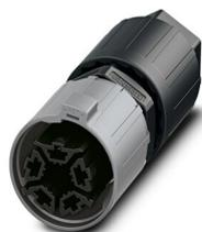
Connecteur, Raccordement QUICKON, nombre de pôles: 4+PE, 690 V, 20 A, noir, avec écrou QUICKON, diamètre extérieur du câble: 9 mm ... 16 mm
