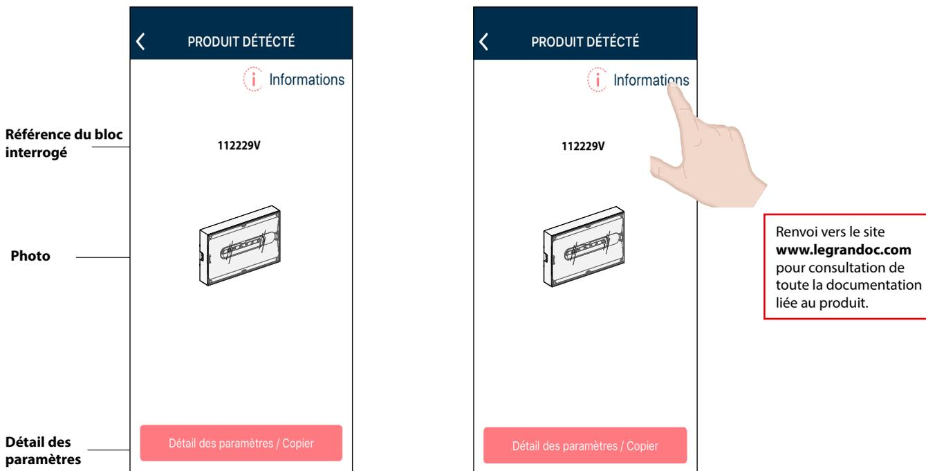
Étape 2 : Cliquer sur "DÉTAIL DES PARAMÈTRES" pour avoir accès à la liste complète des paramètres et à des informations complémentaires. Durant cette étape il faut maintenir la passerelle en direction du bloc interrogé, le chargement des paramètres est visualisable sur l'écran du téléphone.
