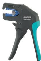
Outil à dénuder, pour câbles et conducteurs (spécialement aussi pour câbles résistants aux défauts à la terre et aux court-circuits) 1,5 - 6 mm<sup>2</sup>, réglage automatique, longueur à dénuder jusqu'à 18 mm, capacité de sectionnement jusqu'à 10 mm<sup>2</sup> flexible/ 1,5 mm<sup>2</sup> rigide, couteau de dénudage remplaçable
