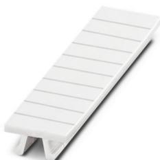
Ruban de repérage ZB, Rubans, blanc, vierge, repérable avec : PLOTMARK, CMS-P1-PLOTTER, type de montage: encliquetage, pour bloc de jonction au pas de : 4,2 mm, surface utile: 4,2 x 10,5 mm, Nombre d'étiquettes: 10
