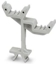
Porte-repère, s'encliquette dans des blocs de jonction à ressort ST 1,5..., repérable avec UC-TM 4, UC-TMF 4, UCT-TM 4, UCT-TMF 4, ZB 4 ou ZBF 4, gris, vierge, type de montage: encliquetage, surface utile: 4 x 10,5 mm
