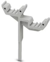
Porte-repère, s'encliquette dans des blocs de jonction à ressort ST 1,5..., repérable avec UC-TM 4, UC-TMF 4, UCT-TM 4, UCT-TMF 4, ZB 4 ou ZBF 4, gris, vierge, type de montage: enfichage, surface utile: 4 x 10,5 mm
