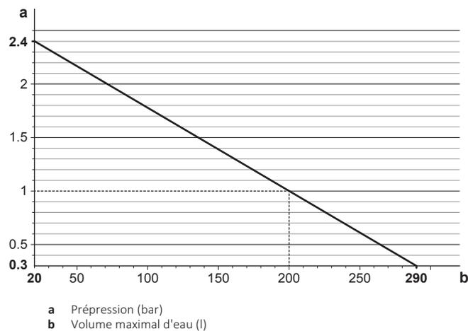
**Exemple: volume maximal d'eau et prépression du vase d'expansion**
