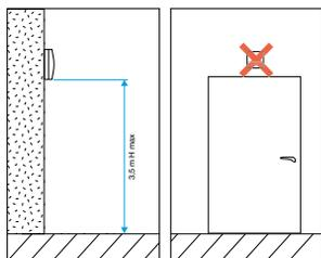
Le capteur doit être placé au centre de la pièce
