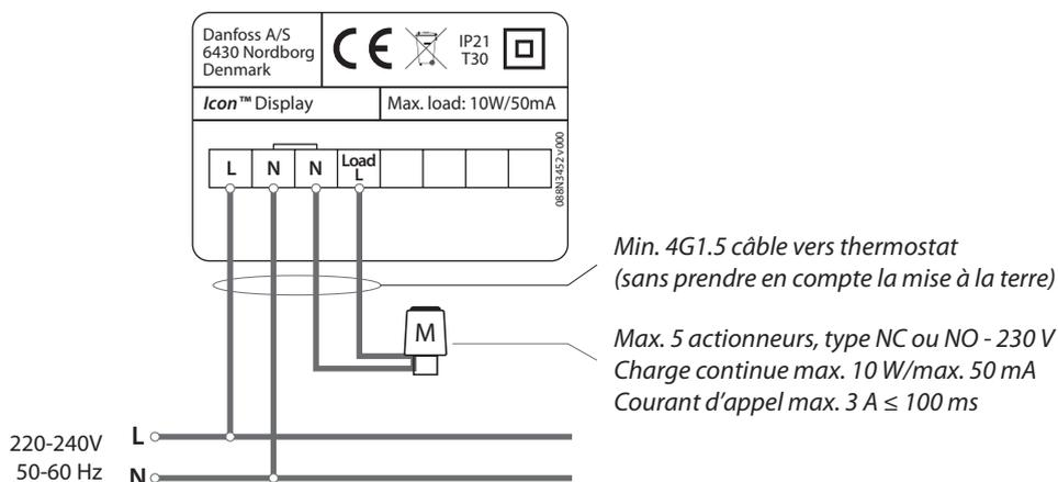
**Câblage avec boîtier de raccordement central**
