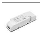
S.2400 ALIMENTATION ELECTRONIQUE NON GRADABLE 35W 230Vac/24Vdc IP20 Entrée: 230V Courant alternatif Sortie: 24V Courant continu. Le nombre maximum d'appareils dépend de la somme des puissances unitaires de l'appareil. CLASSE II SELV Dimensions: 195 x 43 x 30,2 mm L'UTILISATION DU DÉCHARGEUR À SURTENSION S.2499 EST RECOMMANDÉE POUR CHAQUE BALLAST ÉLECTRONIQUE QUI DOIT ÊTRE INSTALLÉ À UNE DISTANCE MAXIMALE DE 10m DE CELUI-CI.
