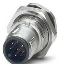
Connecteur d'appareil face arrière, 8-pôles, Connecteur mâle, droit, M12, détrompage: A, Montage face arrière, M16 x 1,5, Picots de soudage, Produit de remplacement selon RoHS II sans exception 6c (Pb < 0,1 %) référence : 1239739
