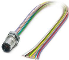
Connecteur d'appareil face arrière, Universel, 17-pôles, Connecteur mâle, droit, M12-SPEEDCONNEC, détrompage: A, sur extrémité libre, Montage face arrière, M12 x 1, Cordons individuels, longueur de câble: 0,5 m, 0,14 mm<sup>2</sup>, Cordon TPE, Produit de remplacement selon RoHS II sans exception 6c (Pb < 0,1 %) référence : 1239648
