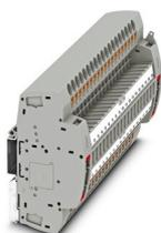
Connecteur de test, Détrompage de type D19 selon la norme allemande VDE, tension nominale: 400 V, nombre de connexions: 38, nombre de pôles: 19, type de raccordement: Raccordement Push-in, 1er étage, Section de référence: 6 mm<sup>2</sup>, section : 0,5 mm<sup>2</sup> - 10 mm<sup>2</sup>, type de montage: NS 35/7,5, NS 35/15, coloris: gris
