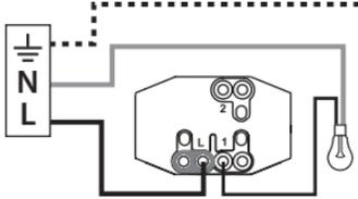
En va-et-vient, commande de 2 endroits différents
