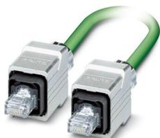
Câble PROFINET préconfectionné, CAT 5e, blindé, quarte en étoile, AWG 22 flexible (7 fils), RAL 6018 (jaune-vert), connecteur mâle RJ45/IP67 boîtier métallique Push-Pull sur connecteur mâle RJ45/IP67 boîtier métallique Push-Pull, Line, longueur : 2 m
