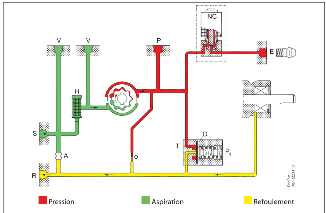
Au démarrage de la pompe, le fioul est aspiré depuis la conduite d'aspiration (S) à travers le filtre (H) jusqu'à l'engrenage (C).
