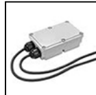
S.2496 DALI RELAY SWITCH pour ON-OFF (NON GRADABLES) 230V APPAREILS Tous les appareils fonctionnant à 230V non gradables (ON-OFF) peuvent être contrôlés ON-OFF avec le système DALI avec les accssoires interfaces suivants. Il s'en suit que l'appareil sera contrôlé à distance dans le seul mode ON-OFF et non pas en mode gradable. IP67 Max nominal load 1000VA Max switching current 8A Max inrush current 80A Dimensions 175,5mm x 86,5mm x 43mm
