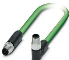
Câble de réseau, PROFINET CAT5 (100 Mbit/s), EtherCAT® CAT5 (100 Mbit/s), 4-pôles, blindé (Advanced Shielding Technology), connecteur mâle droit M8, détrompage: D / IP67, sur connecteur mâle coudé M8, détrompage: D / IP67, longueur de câble: 5 m
