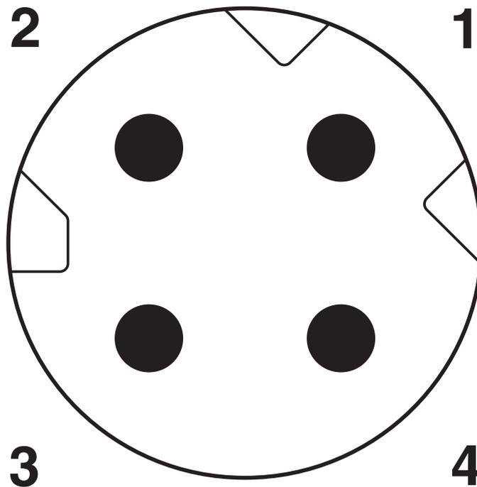
Brochage connecteur mâle M8, 4 pôles, détrompage D, vue côté mâle
