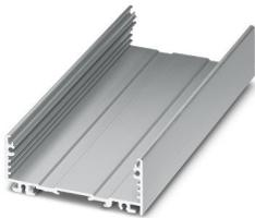
Boîtier pour profilé extrudé, Montage vissé, Profil de base, coloris: couleurs aluminium, largeur du profilé (intérieure): 72 mm, largeur du profilé (extérieure): 75 mm, longueur: 60 mm, profondeur: 29,4 mm
