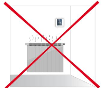
(ES) La altura del termostato no debe ser superior a 2 m con respecto del suelo. (EN) The height of the thermostat must not be more than 2 m from the ground. (FR) La distance entre le thermostat et le sol ne doit pas excéder 2 mètres. (IT) L'altezza del termostato non deve superare i 2 m dal pavimento. (DE) Die Höhe des Thermostats darf nicht mehr als 2 m über dem Boden liegen.
