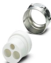
Presse-étoupe métallique multiple Pg21, composé d'un joint d'étanchéité caoutchouc avec plusieurs trous (1 x 6 mm / 2 x 9 mm) et d'une vis de pression, pour manchons pour presse-étoupe VC-M-KV-PG21...
