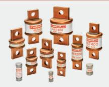
Les fusibles A3T et A6T de Classe T à action rapide possèdent deux avantages majeurs - une haute limitation de courant et de petites dimensions. Leurs dimensions uniques préviennent leur substitution par des fusibles de moindres calibres ou de capacité de limitation de courant inférieure.
