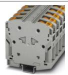
Bloc de jonction pour courant, Mode de raccordement: Raccordement Power-Turn, Nombre de connexions: 2, Section :10 mm² - 70 mm², AWG: 8 - 2/0, Largeur: 20 mm, Coloris: gris, Type de montage: NS 35/15
