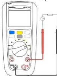
MTX 204 zakres \mu\text{A}
