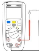
MTX 204 Messbereich \mu A
