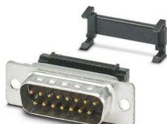
Isolant pour contact D-SUB , taille Shell 2, avec 15 contacts de signalisation, type de contact mâle, raccordement pour câble en nappe, coudé, fixation au moyen d'un perçage de 3 mm, pour cadre de montage VS-15-...
