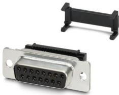
Isolant pour contact D-SUB , taille Shell 2, avec 15 contacts de signalisation, type de contact femelle, raccordement pour câble en nappe, coudé, fixation au moyen d'un perçage de 3 mm, pour cadre de montage VS-15-...
