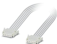
Connecteurs mâles pour C.I. câblés / Câble de connexion avec 2 connecteurs mâles pour C.I., courant de référence: 6 A, longueur de câble: Longueur au choix (0,1 ... 3,0 m), Tête 1: 8-pôles , pas: 2,5 mm , Raccordement à sertir , Connecteur femelle, Coloris: blanc, Type de câble: Toron individuel, PVC, 22 AWG, blanc, Tête 2: 8-pôles, pas: 2,5 mm , Raccordement à sertir , Connecteur femelle, Coloris: blanc, Type de câble: Toron individuel, PVC, 20 AWG, blanc, Toron individuel, PVC, 22 AWG, blanc
