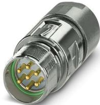
M23, Connecteur prolongateur, série: M23 PRO, droit, blindé: oui, Pour verrouillages rapides standard et ONECLICK, Nombre de pôles: 7, Sens de rotation: standard, type de contact: Mâle, Raccordement soudé, plage de diamètre de câble: 6 mm ... 10 mm, détrompage: N, L'article est sans plomb, conformément à la directive RoHS II, sans exception 6c (Pb < 0,1 %)
