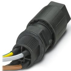
Traversée de paroi, Raccordement QUICKON, nombre de pôles: 3+PE, 690 V, 17,5 A, noir, avec écrou QUICKON, diamètre extérieur du câble: 10 mm ... 13 mm, filetage de montage: M20, Fils individuels, 1,5 mm<sup>2</sup>, longueur du câble: 0,15 m, Embouts
