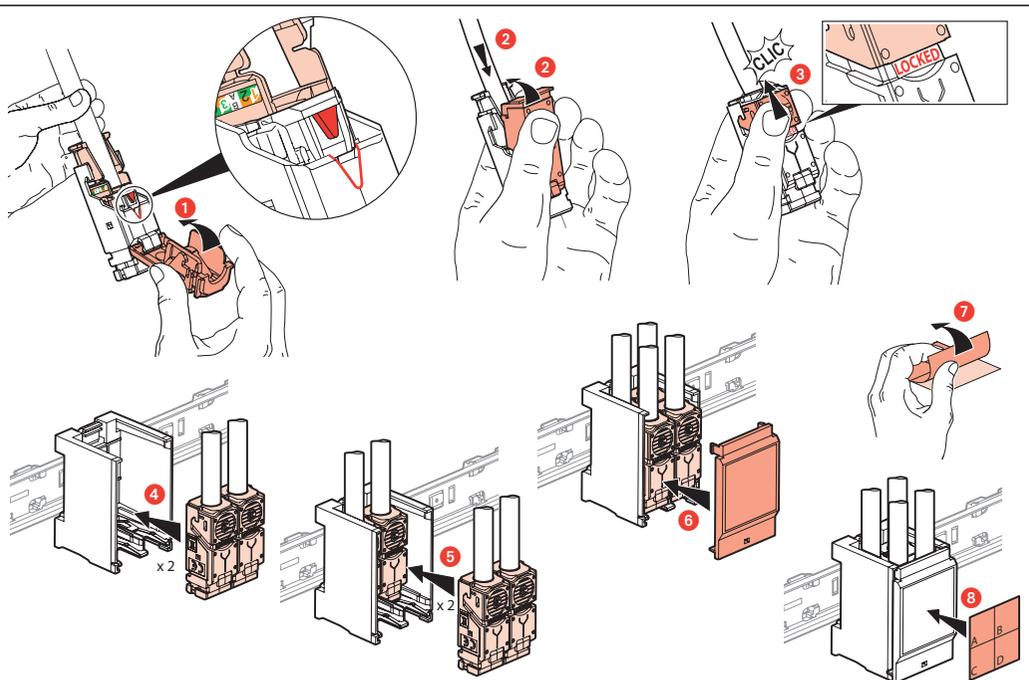
4 connecteurs supplémentaires avec support RJ 45 UTP réf. 4 131 79 et connecteurs RJ 45 Cat 6 UTP réf. 4 131 81 (en option)
