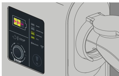
Fine del tempo programmato "Ricarica del veicolo" (scorrimento verde) Spie "3h/6h/9h" spente
