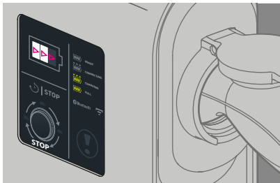
"Borne connectée au véhicule" (défilement blanc ou vert) "Charging station connected to the vehicle" (white or green scrolling)
