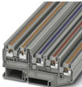
Bloc de jonction pour capteurs / actionneurs, Mode de raccordement: Raccordement Push-in, Section :0,14 mm 2 - 1,5 mm 2 , AWG: 26 - 14, Largeur: 3,5 mm, Coloris: gris, Type de montage: NS 35/7,5, NS 35/15
