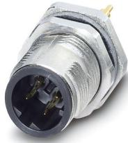
Connecteur d'appareil face arrière, 4-pôles, Connecteur mâle, droit, M12-SPEEDCONN, détrompage: D, Montage face arrière, M12 x 1, Picots de soudage, Produit de remplacement selon RoHS II sans exception 6c (Pb < 0,1 %) référence : 1240023
