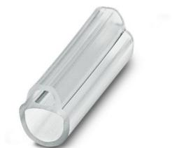
Repères pour fils, transparent, vierge, type de montage: enfilage, plage de diamètre de câble: 0,6 ... 1,2 mm, surface utile: 15 x 4 mm
