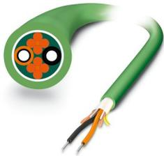
Câble PROFINET POF ultrasouple à confectionner (uniquement têtes IP20), adapté à une utilisation avec des chaînes porte-câbles. Eléments individuels en polyamide (PA) très résistant. Le câble est exempt d'halogène, résistant à l'ozone et aux UV et possède une gaine extérieure robuste en polyuréthane (PUR).
