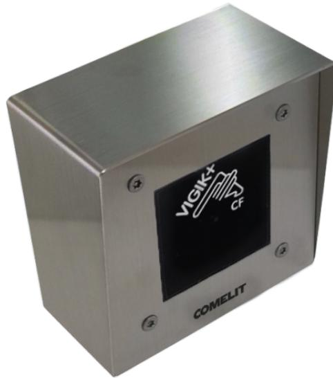
Lecteur VIGIK+ antivandale. Façade inox 2 mm et polycarbonate 6mm. Fixation par 4 vis antivandales. Compatible avec les centrales de la gamme ResiCloud. Fermeture par 4 vis anti vandales avec outil fourni Inclus boîtier de saillie inox Comelit. Dimensions façade (L x H x P): 110 x 110 x 2 mm. Dimensions boîtier (L x H x P): 118 x 116,5 x 70 mm.
