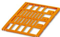
Repère pour conducteur, Planche, orange, vierge, repérable avec : BLUEMARK ID COLOR, BLUEMARK ID, BLUEMARK CLED, PLOTMARK, CMS-P1-PLOTTER, type de montage: insertion, plage de diamètre de câble: 1,5 ... 35 mm, surface utile: 23 x 4 mm, Nombre d'étiquettes: 24
