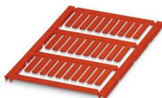
Repère pour conducteur, Planche, rouge, vierge, repérable avec : TOPMARK NEO, LASER TOPMARK, BLUEMARK ID COLOR, BLUEMARK ID, BLUEMARK CLED, THERMOMARK PRIME, THERMOMARK CARD 2.0, THERMOMARK CARD, type de montage: insertion, plage de diamètre de câble: 1,5 ... 35 mm, surface utile: 23 x 4 mm, Nombre d'étiquettes: 30
