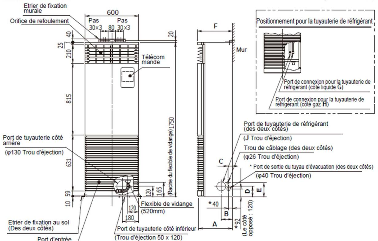
\* Le port d'extraction du tuyau de vidange (des deux côtés) concerne uniquement les modèles RM110 à RM160. Pour raccorder le tuyau d'évacuation à droite ou à gauche, passez-le dans le trou défonçable pour les tuyaux de réfrigérant sur les modèles RM56 à RM80.
